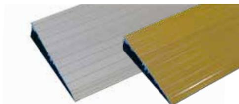
La rampe de seuil est un système modulaire breveté conçu pour franchir les dénivellations de 1,5 à 3 cm. La hauteur peut être réglée de différentes manières : avec le jeu de pieds fournis ou en vissant la rampe au seuil. La dénivellation à franchir peut ainsi être augmentée jusqu'à 5 cm au maximum en associant 2 rampes de seuil avec un jeu de connecteurs. Autres dimensions disponibles sur demande.
